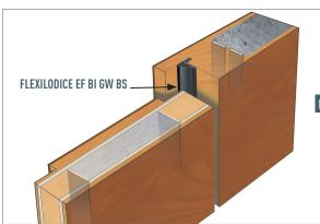
• Umlaufdichtungen für Brand- und Schallschutz Türblätter.
